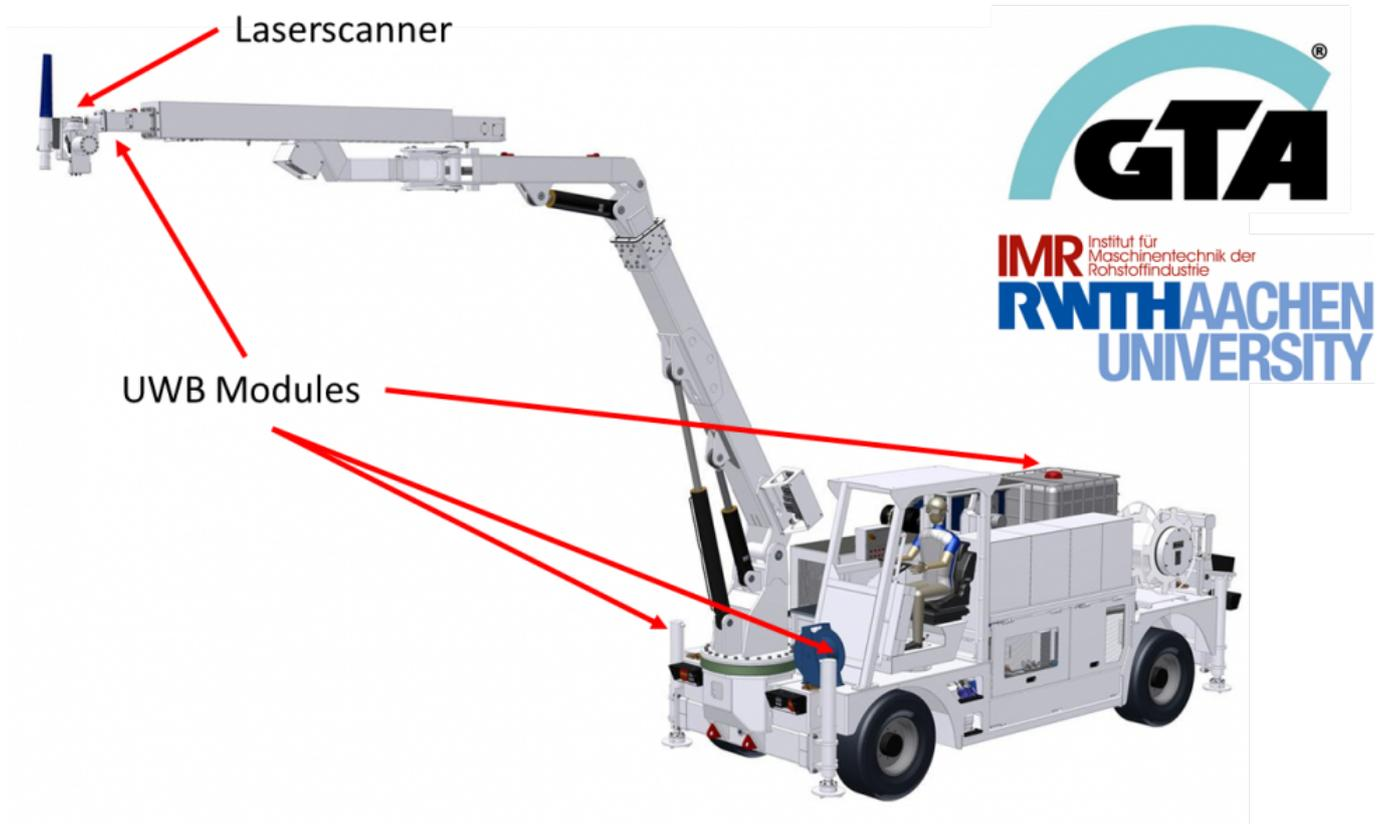
Die Entwicklung der Lokalisierungstechnologie bestehend aus UWB und INS inklusive der geschickten Sensordatenfusion wurde am Institut Advanced Mining Technologies durchgeführt. Außerdem wurde die Laserscannertechnologie und die zugehörige Software am AMT entwickelt. Dabei lag besonderes Augenmerk auf der Algorithmik und der Zeitsynchronisation der UWB-Module.
